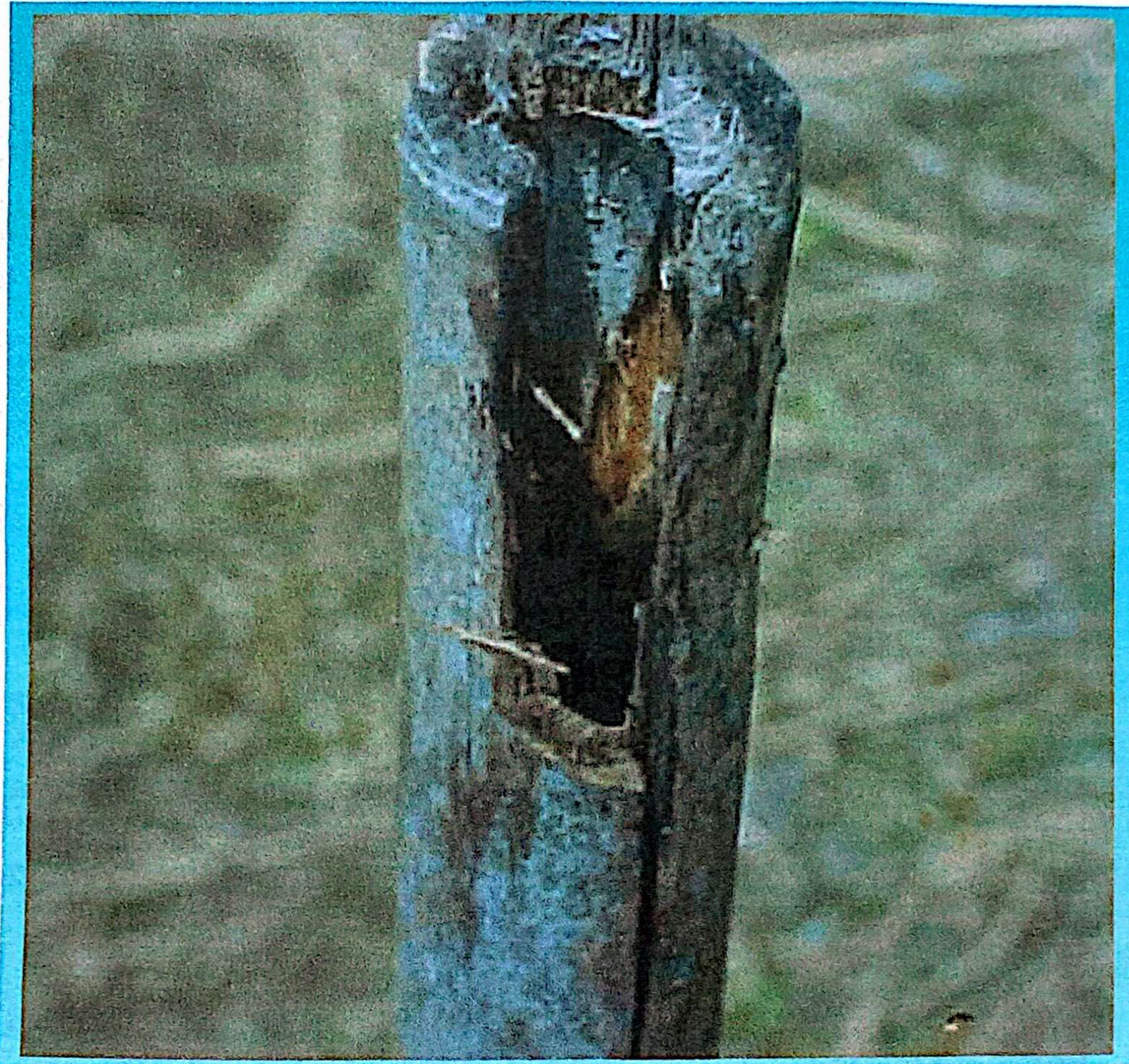
Figura 7. Probeta con pudrición del nudo y entrenudo superior
